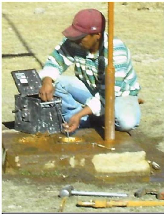
用电子探管进行的 SWL 测量。
