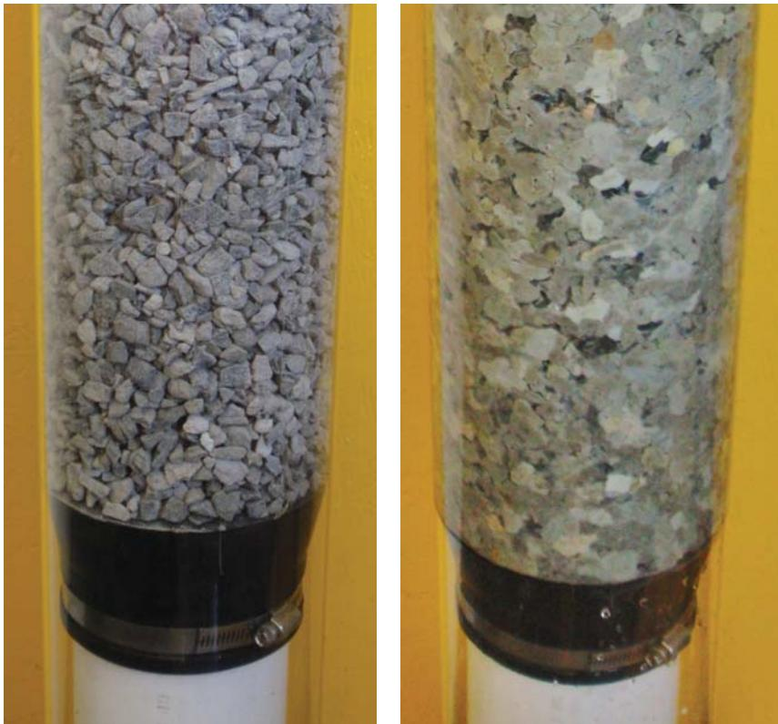
初始水合作用前（左）、后（右）的碎粒膨润土。碎粒膨润土围绕着一个透明塑料管（用于演示目的）内的白色PVC套管。
